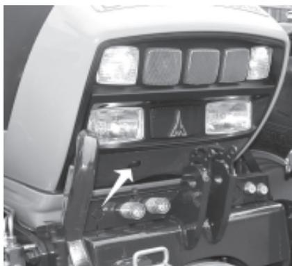
Pour ouvrir le capot, appuyez sur le bouton situé sur la face avant du capot et lever ensuite le capot jusqu'à la verticale ;
