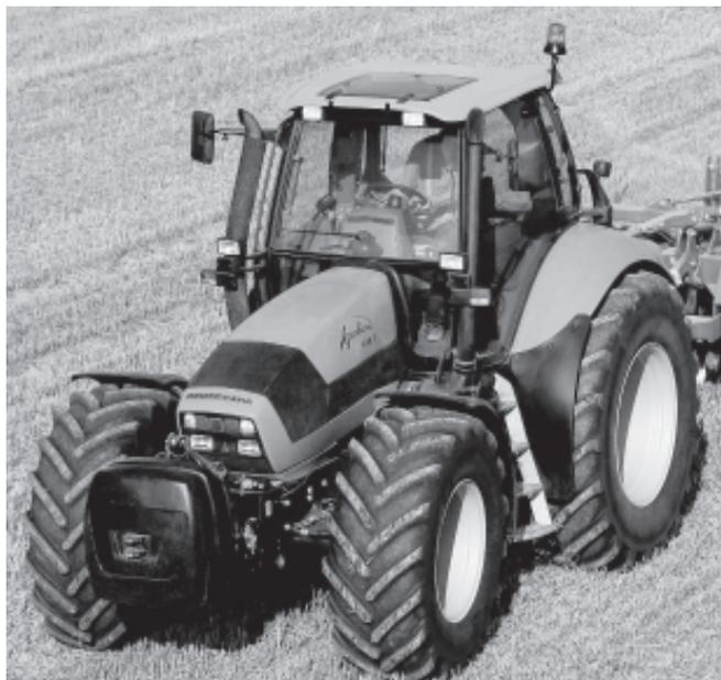
Le capot frontal basculant facilite l'accès pour l'entretien du moteur.
