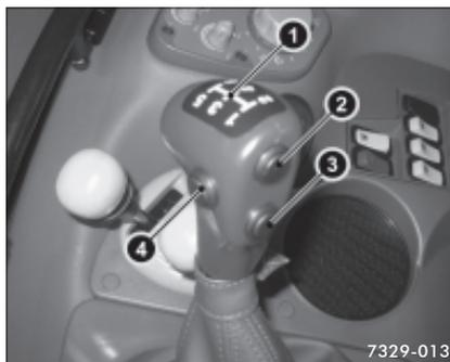
Les deux touches (+) / (-) sur le levier de vitesses permettent de choisir les rapports avec passage sous charge dans les 4 gammes disponibles : **L** (lente), **M** (moyenne), **H** (haute), **S** (rapide).
